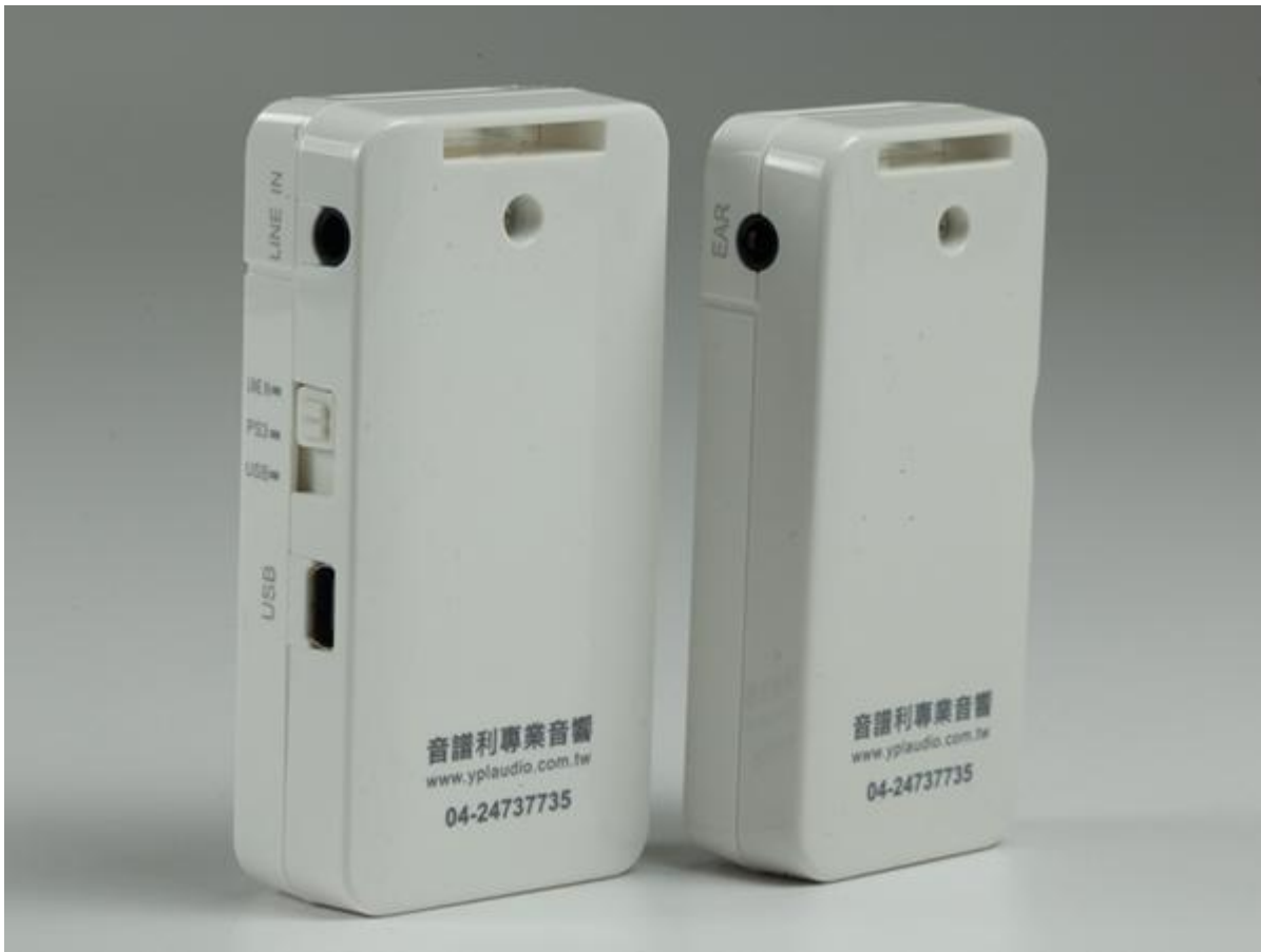
圖左：T-100 無線發射器，最上方有一個 3.5mm 輸入，底下有 Mini USB 輸入，中間則是輸入切換。圖右：R-100 無線接收器，最上方的 EAR 就是 3.5mm 類比輸出端子。
